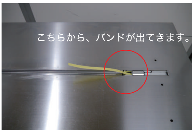
⑤電源を入れ、送りボタンを押して天板の中央レールからバンドが出てくればOKです。 (バンドが曲がっていたり、よれていた場合は、上手くバンドが入っていきません。 その場合、ハサミでバンドの先端を切って整えて下さい。)
